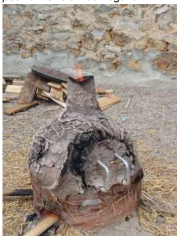
Le four terminé et en fonctionnement. Voyez les flammes qui sortent par la cheminée
